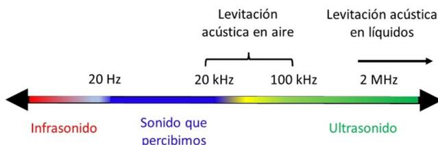
Figura 1. Ilustración de rangos de frecuencias de ondas acústicas. Para la levitación acústica en aire, generalmente se emplea el rango de 25 – 100 kHz.
